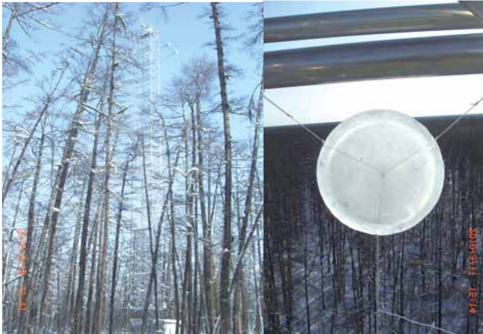
Fig. 1 カラマツ林の 32m 森林境界層観測タワー(左)およびタワーに取り付けた氷ブロック(右)
