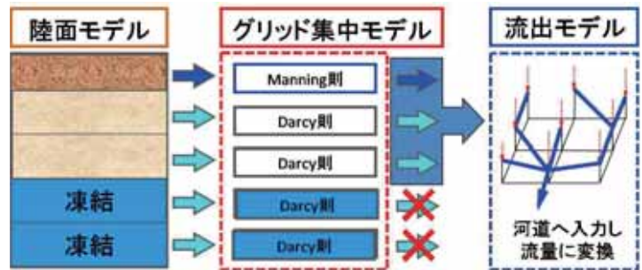
図6 陸面モデル，グリッド集中モデル，流出モデルの関係
